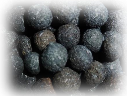
Рис. 2. Гранулированный нефтесорбент «Олеосорб»
